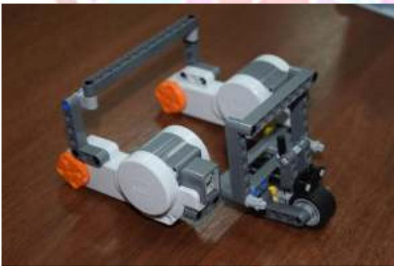
На финальном этапе сборки устанавливаем блок NXT и колеса на нашего робота.
